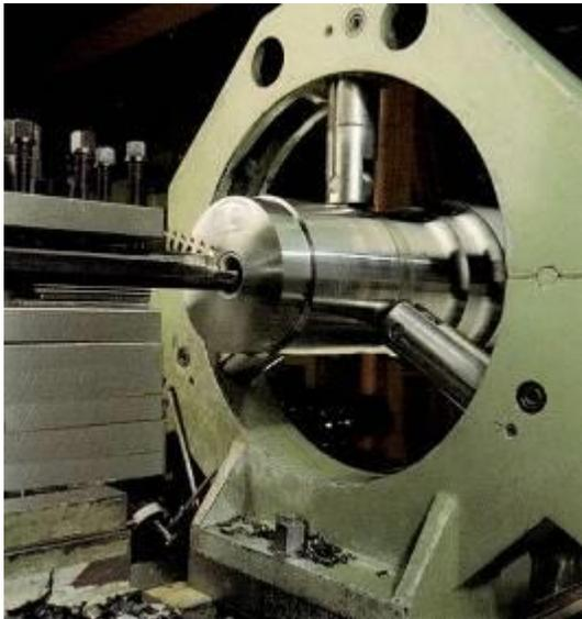
L'utilisation de machine CNC la plus sophistiquée nous aidera à atteindre la constance en termes de qualité, de précision, de vitesse et de polyvalence. L'utilisation de la perceuse-taraudeuse entièrement automatisée et de la rectifieuse CNC hautement précise garantira que chaque essieu sort de la ligne avec une perfection maximale.
